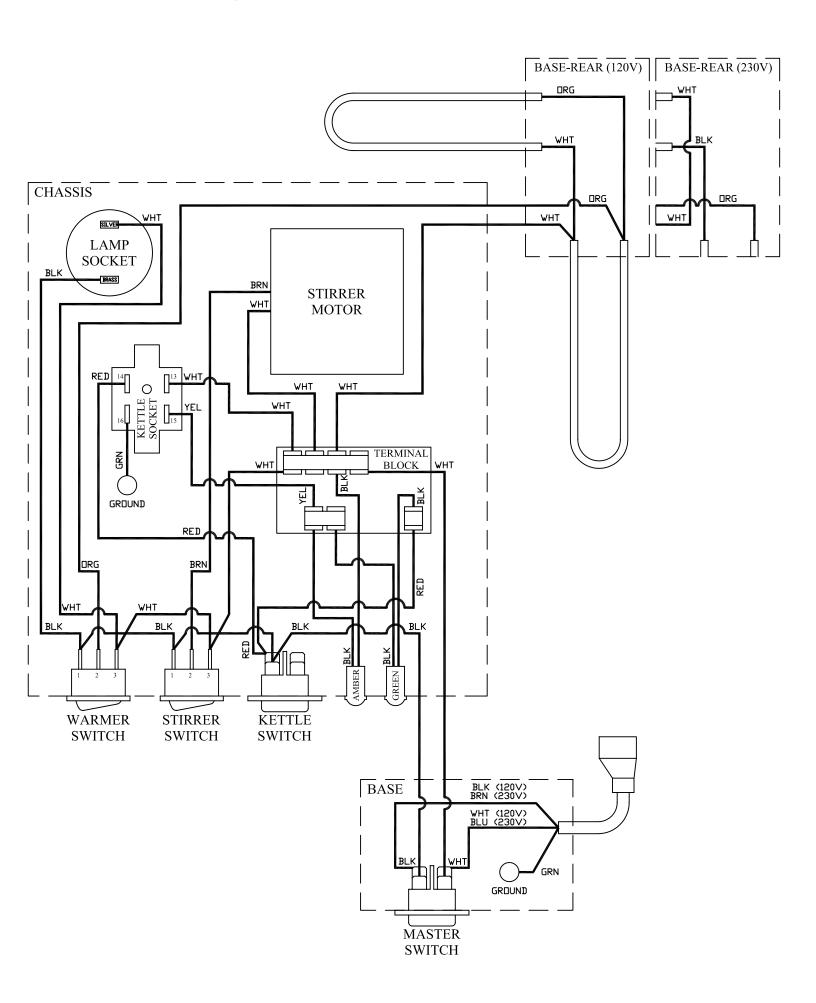
CLP-16 WIRING DIAGRAM (120V)
